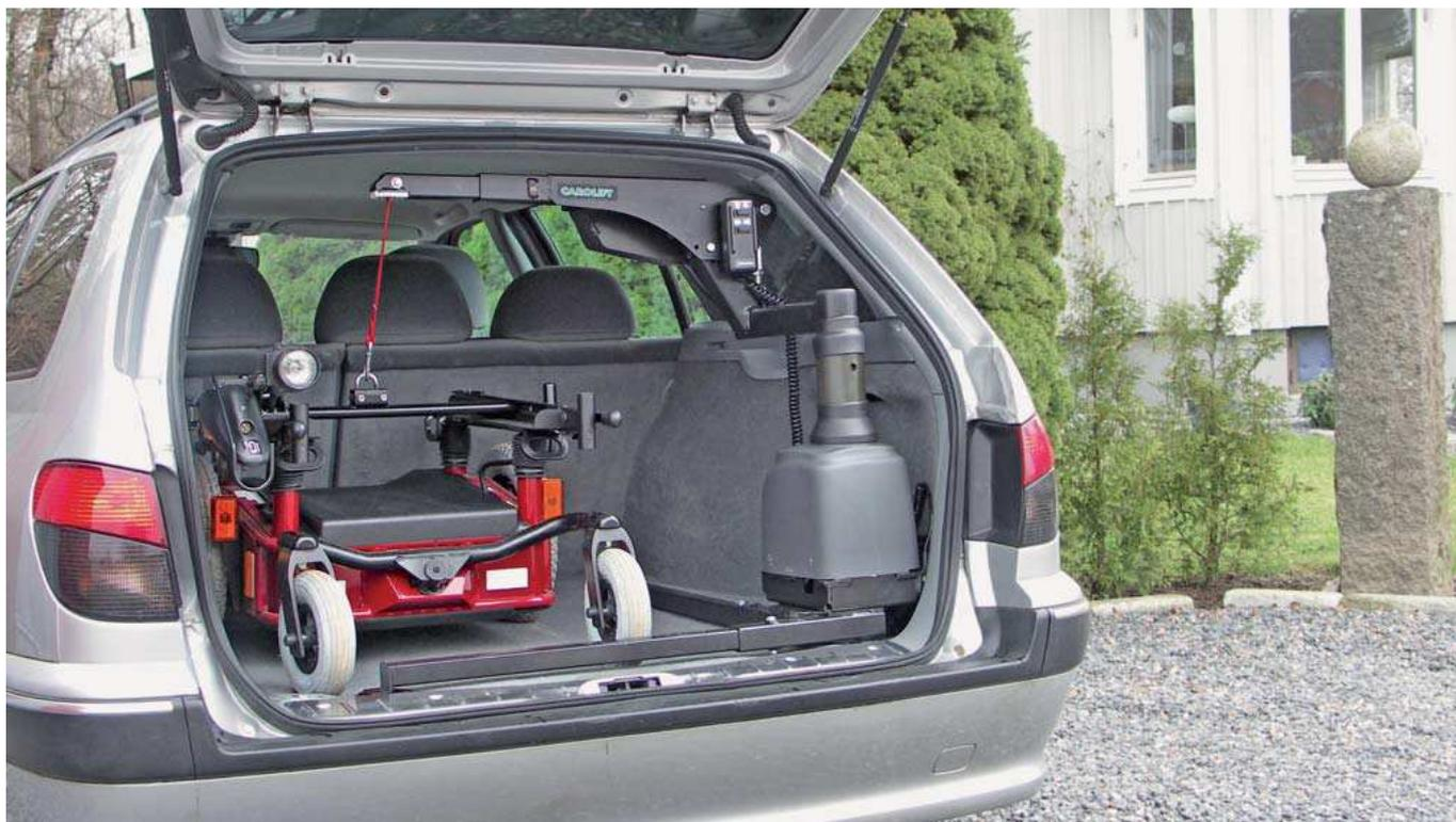
**Grue de chargement, pour fauteuil roulant électrique ou scooter.**
